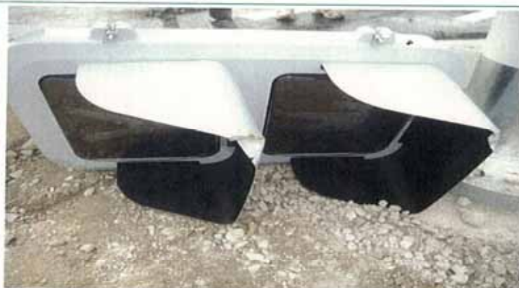
県警歩道用信号機灯具(未共用)破損
