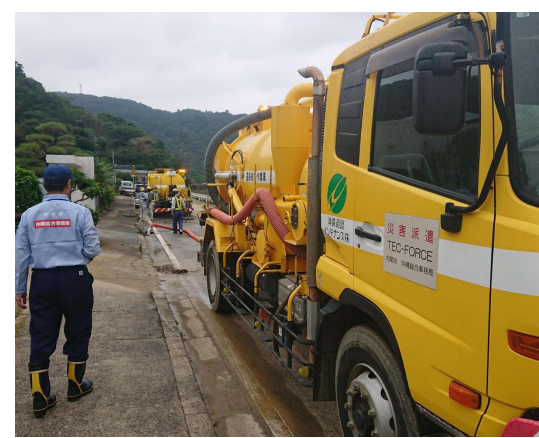
側溝清掃車で土砂撤去支援
