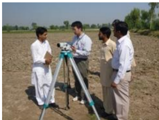
測量機器を用いたほ場の均平状況の確認手法を技術移転 (パキスタン)
