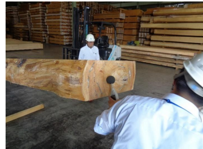
運搬前立会検査(強度検査)
