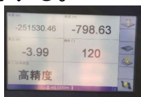
ICTバックホウの刃先等の施工履歴データを記録
