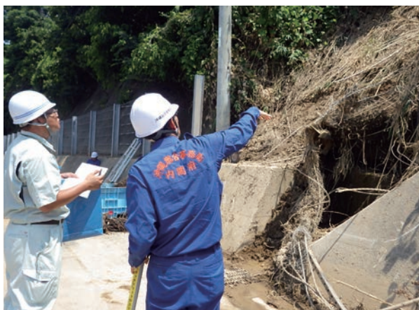
大雨により崩壊した斜面の調査（愛媛県 西予市）
