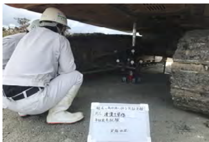
平板載荷試験状況
