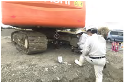
平板載荷試験状況
