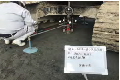
平板載荷試験状況
