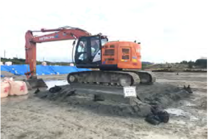
平板載荷試験状況
