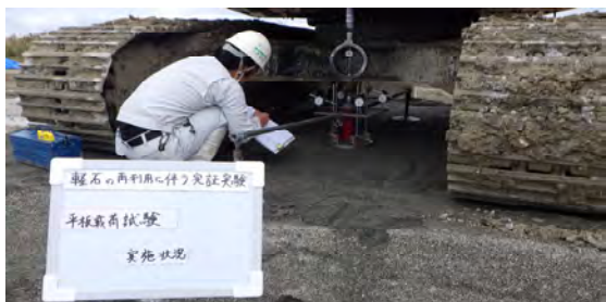
平板載荷試験状況
