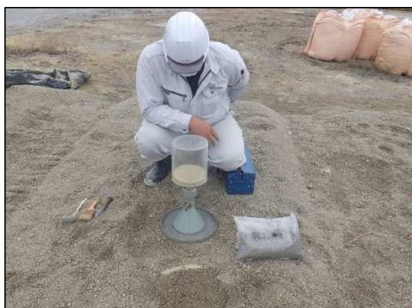
砂置換測定状況(軽石)
