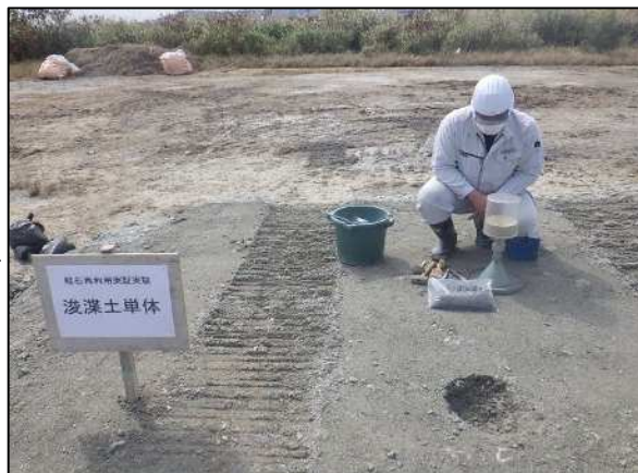
測定状況(砂置換)
