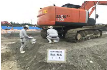
平板載荷試験状況
