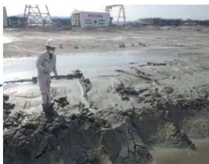
写真 3. サンプル ③ 試料採取
