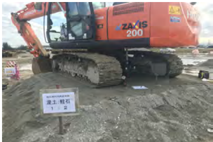
平板載荷試験状況
