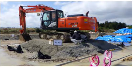
平板載荷試験状況
