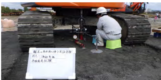
平板載荷試験状況
