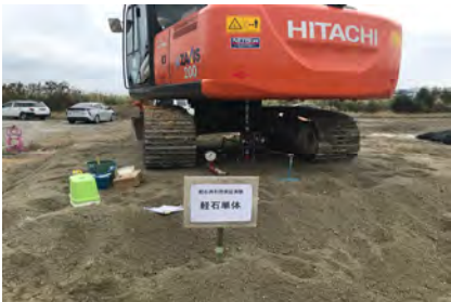
平板載荷試験状況
