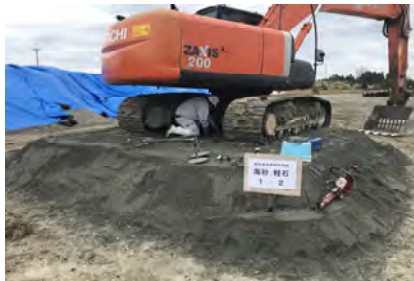
平板載荷試験状況
