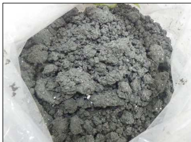
サンプル② 混合後 (添加量60kg/m 3 )
