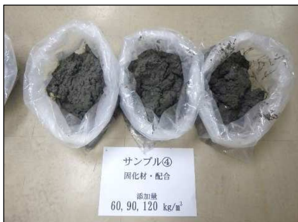
サンプル④ 混合後（ビニール袋にて養生）
