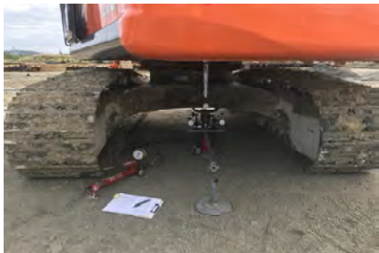
平板載荷試験状況
