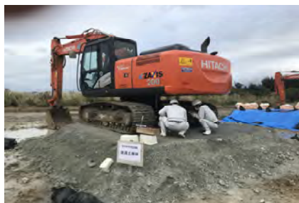
平板載荷試験状況
