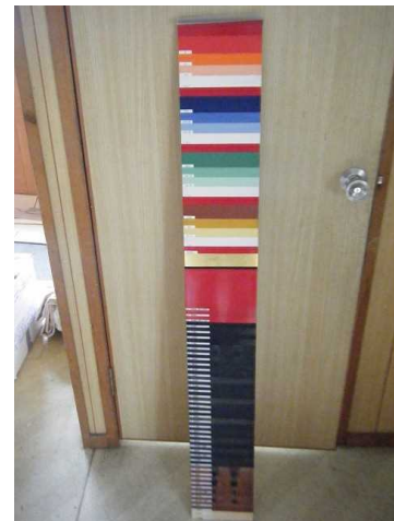
工程手板による彩色塗装工程の説明
