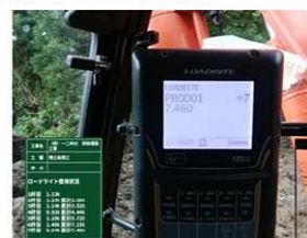
積み込み作業の様子（内部モニターに累計重量が表示される）
