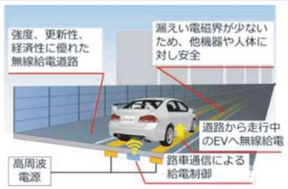
▲走行中給電施設
