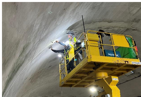
【近接目視点検・打音検査】
