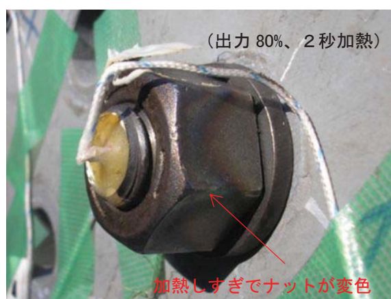
写真 11.3 過剰な IH 加熱でナットが変色
