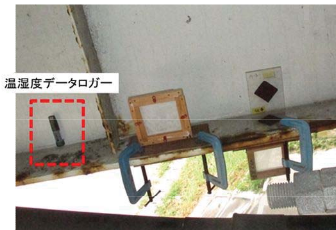
写真 2.2.2 温湿度データロガー設置状況
