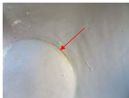
写真-1.2 ボルト頭部のわれの状況
