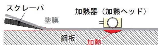
電磁誘導により鋼板を加熱し、塗膜を剥離する工法
