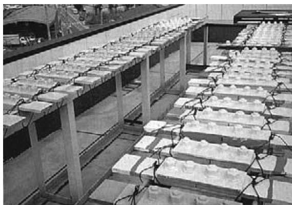
写真-5 塗装したミニ継手部の屋外暴露
