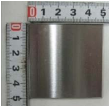
写真 2.5.1 ワッペン試験片 (SMA 鋼)
