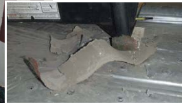
剥離させた塗膜 (塗膜が板状に剥離)
