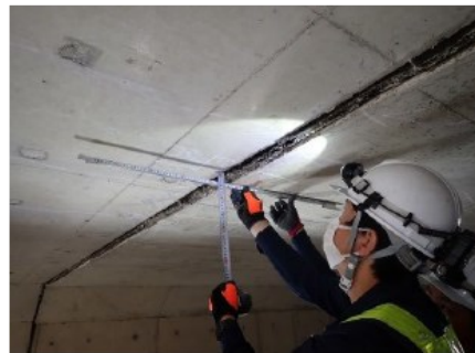
高所作業車等を用いたカルバートの目視・打音調査
