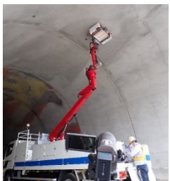
レーザー打音による変状の把握
