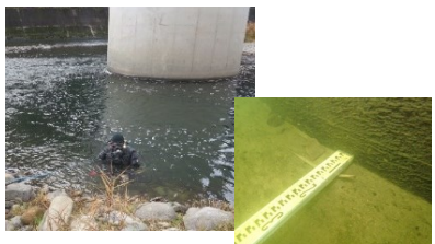
潜水調査による河床洗掘の把握
