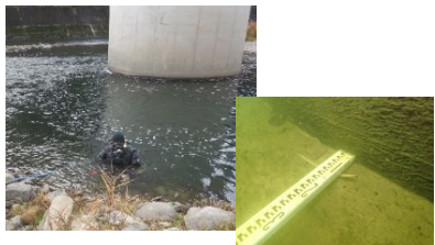
潜水調査による河床洗掘の把握
