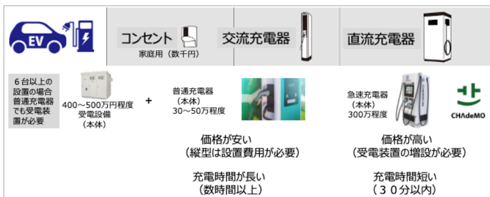
図12 急速充電器（直流電源）と普通充電器（交流電源）の違い
