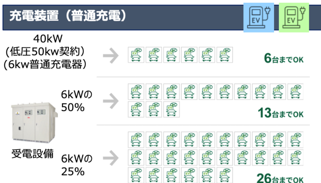
図13 普通充電器であっても複数台の設置の場合は受電装置が必要
