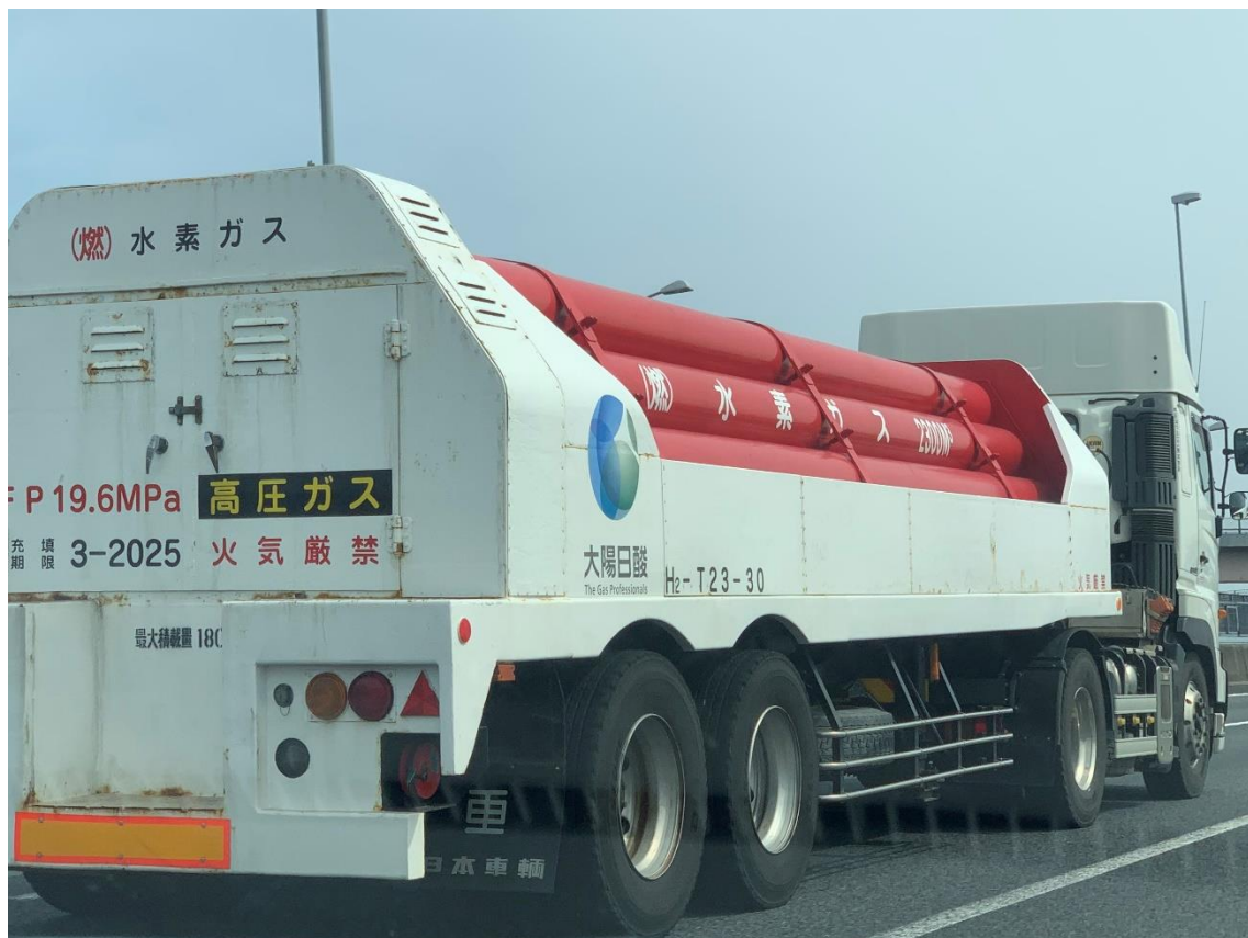
図 14 19.6MPa×660L×20 本組 水素ローダーの外観(写真)
