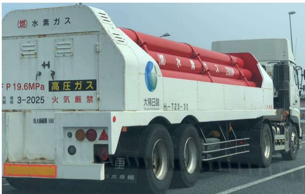
図 20 19.6MPa×660L×20 本組 水素ローダーの外観(写真)
