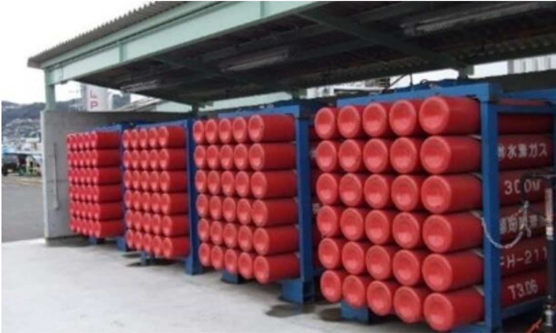
図 13 19.6MPa×50L×30 本組 水素カードルの外観(写真)
