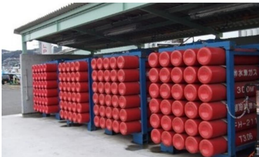
図 19 19.6MPa×50L×30 本組 水素カードルの外観(写真)
