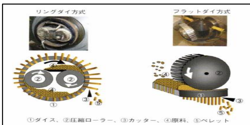
図9 リングダイ方式とフラットダイ方式 [5]
