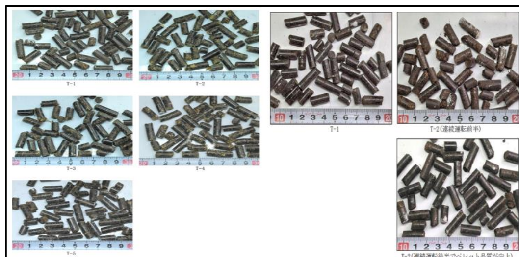
図 15 前ペレ(左), 後ペレ(右)ペレット外観
