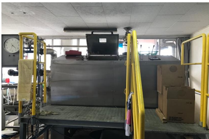
図 8 実際に用いた真空乾燥機
