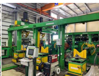
自動溶接ライン先端部と鋼管部の接続溶接及び完成品の搬出が可能
