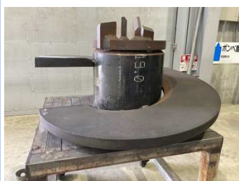
曲加工機で成形された翼図面通りの形状に成形が可能
