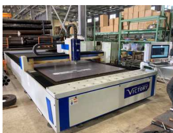
レーザー切断機(中国製)厚さ12ミリ以上の切断が不安定
