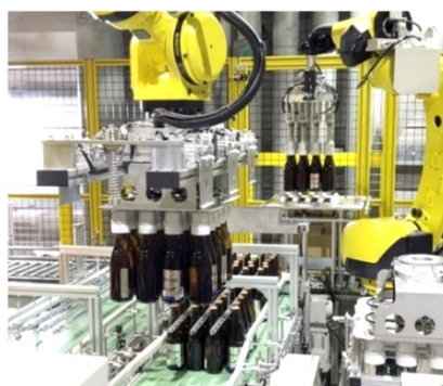
① ロボットケーサーによる箱詰め替えの様子
