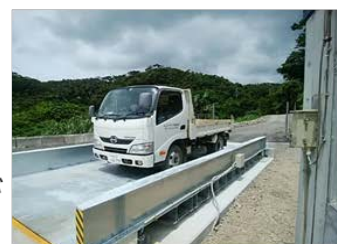
【トラックスケール】
