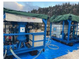
可搬式浄水装置（水資源機構）2台で作った水を北陸地整運搬
