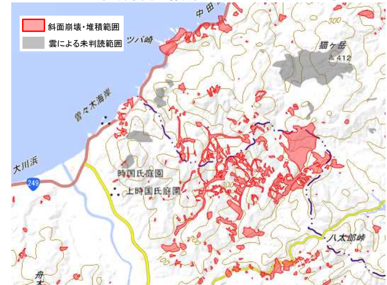
斜面崩壊・堆積分布図(珠洲市と輪島市の境界付近)
