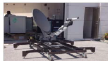
衛星回線を用いた可搬基地局
