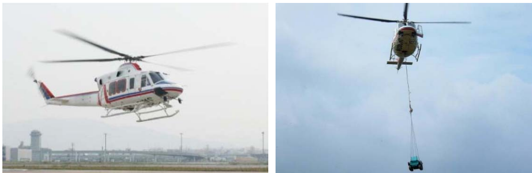
写真-（左）輸送ヘリコプター：ベル 412EP（西日本空輸）、 （右）ヘリコプターによる建設機械の輸送状況
