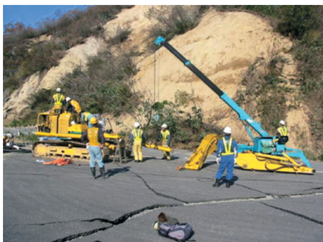
写真-油圧ショベルの現地組立状況
