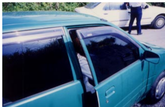
不正改造の例：運転席側窓ガラスへの着色フィルム貼り付け
