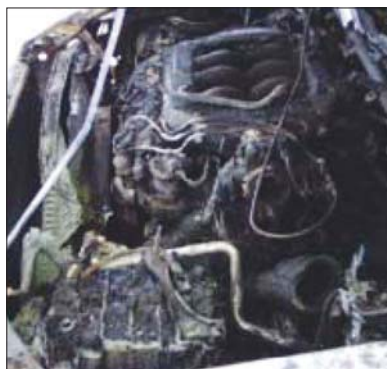
燃料系統部品の腐食を原因として、火災が起きた事例
