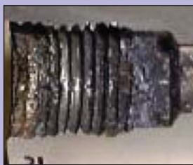
デリバリーパイプの腐食状況 98年型 走行距離 約17,000Km
