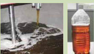
泡盛かすをメタン発酵によりガス化（宮古島市）
