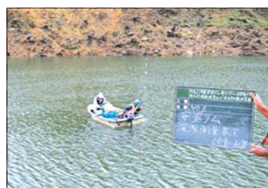
堆砂測量状況
