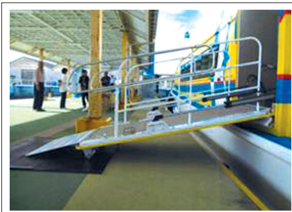
船内から開閉作業が可能な油圧式タラップ
