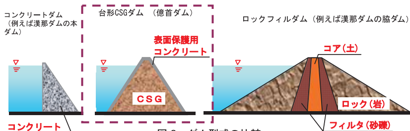
図-2 ダム型式の比較
