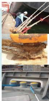
係船索で船を岸壁に固定
