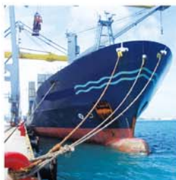
係船索で船を岸壁に固定
