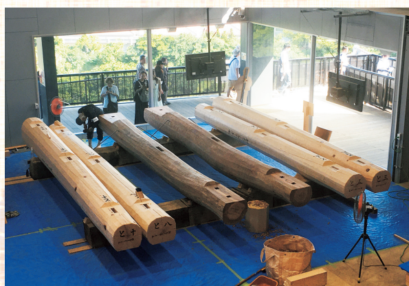
木材倉庫・原寸場見学エリア(R4.10～ 内部より撮影) (小屋丸太梁加工状況 内側の2本はオキナワウラジログシ)
