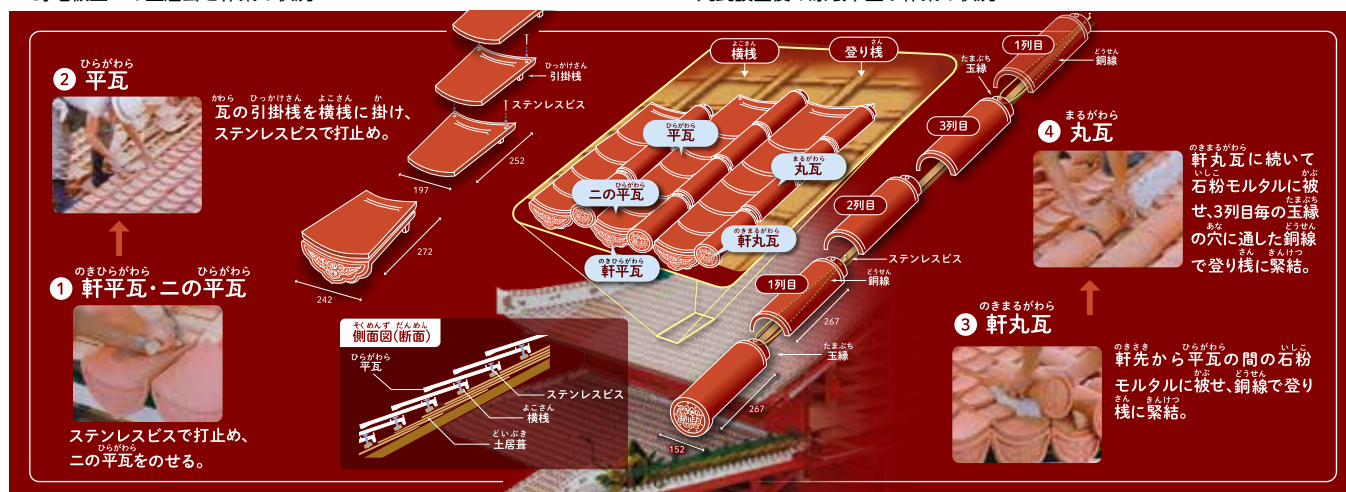
図1 瓦の組み方（空葺き工法）の手順
