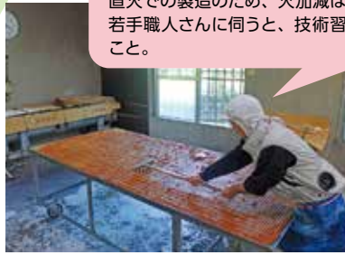
【冷却・カット】 煮詰めた液体を引き延ばしながら冷却し、 長方形にカット、ヘラで剥がし手作業でひ とつずつ切り離す。冷えると同時に固まっ ていくため、タイミングよく作業する。
