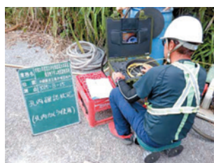
沖縄総合事務局長表彰 (業務) (有) 地建 写真：孔内カメラによる孔内確認
