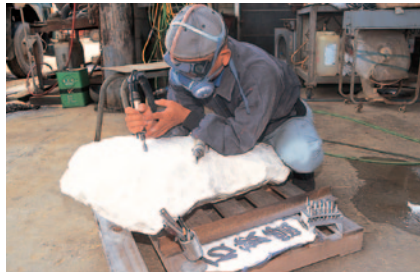
防塵マスクもオリジナル。ガラスの曇り予防に空気が送られる仕組み。買うと高いので手作りしたそう。
