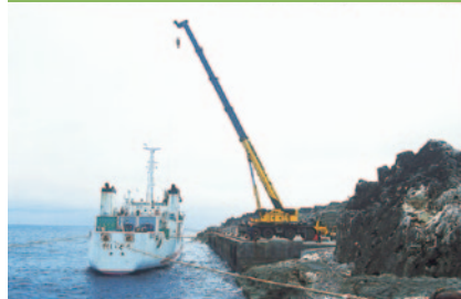
北大東島の港には船が接岸できないため、荷物も人もクレーンで積み下ろす。
