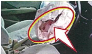
写真:エアバックが異常破裂し中部の金属部品が飛び散りバッグの中央部が大きく裂けている状態
