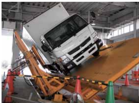
傾斜角度測定検査
