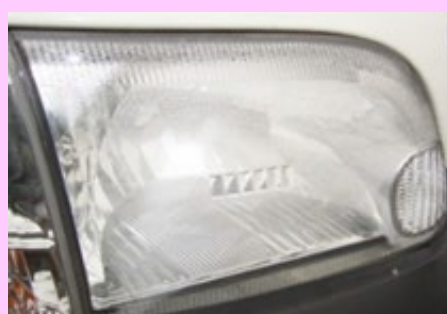
内部リフレクタの劣化
