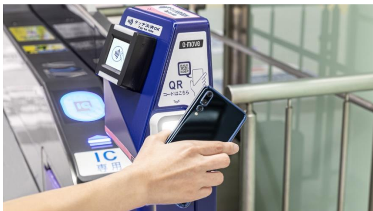
図 4.71 改札機に設置されたカード未対応の専用改札機 (南海電気鉄道の HP より)
