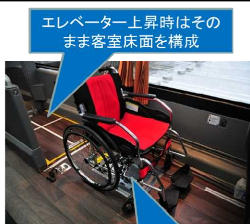
新しいタイプの車椅子固定装置
