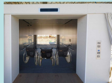
エレベーターの実物大の検証模型
