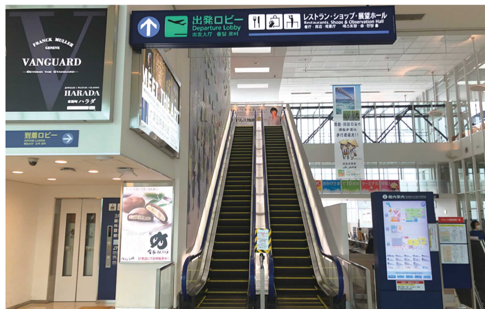
徳島空港 / 一般旅客と車椅子使用者旅客が同じ動線となっている1階から出発ロビー階までの縦動線
