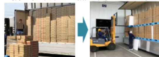
バラ積み・バラ降ろしによる非効率な荷役作業 → パレットの利用による荷役時間の短縮
