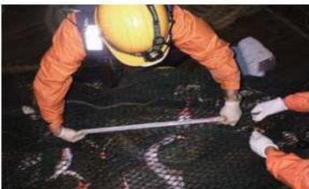
中国底びき網漁船の漁具の目合い(網目の大きさ)検査
