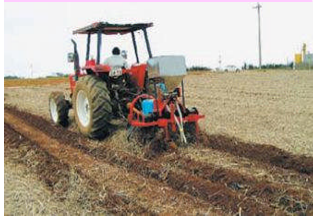
株揃え、施肥、農薬散布の3行程を同時に行える株出管理機
