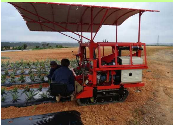
パイン植付機による植付け状況（東村）
