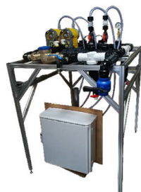
自動灌水・施肥制御装置
