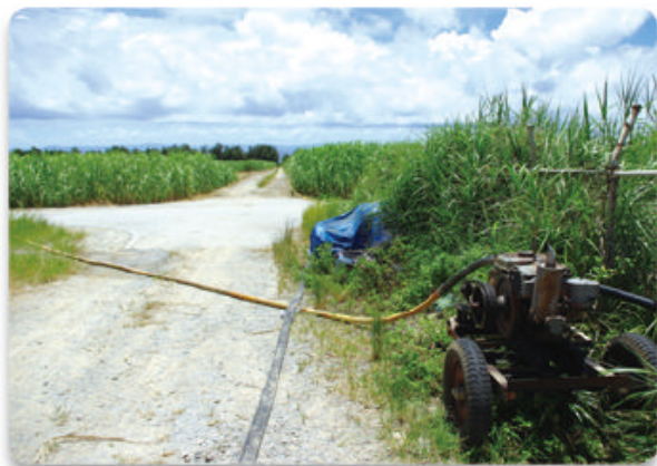
ため池は、貴重な水源。 ポンプで水を汲み上げ、ホースを引く。 ホースは長いところで1～2kmにも及ぶ。
