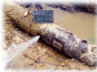
管の腐食による漏水
