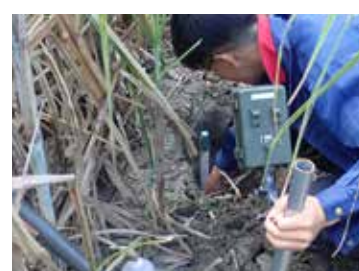
土壌水分計の設置
