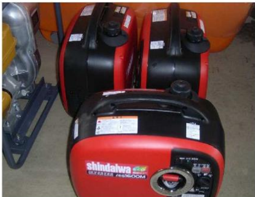
携帯用発電機
